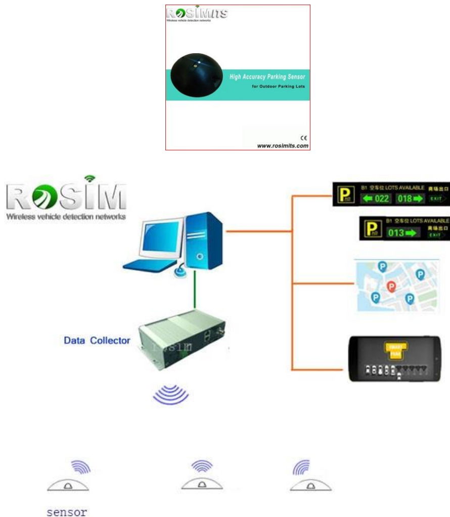
Obr. 2.2.13 Schéma technického riešenia ROSIM; Zdroj: 5
