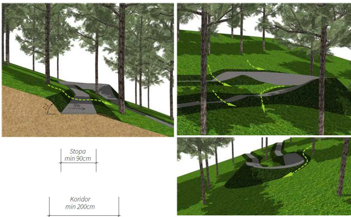
Obrázok 12: Príklad realizácie trasy typu flowtrail v záreze a naklonej zákruty pre zmenu smeru pri priečnom sklone svahu 33%
